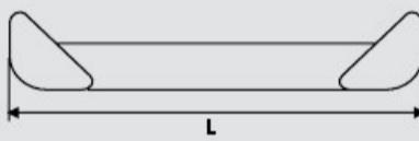
С деревянной багетной планкой, потолочный крепеж. Начинка трехрядная пластиковая шина.
