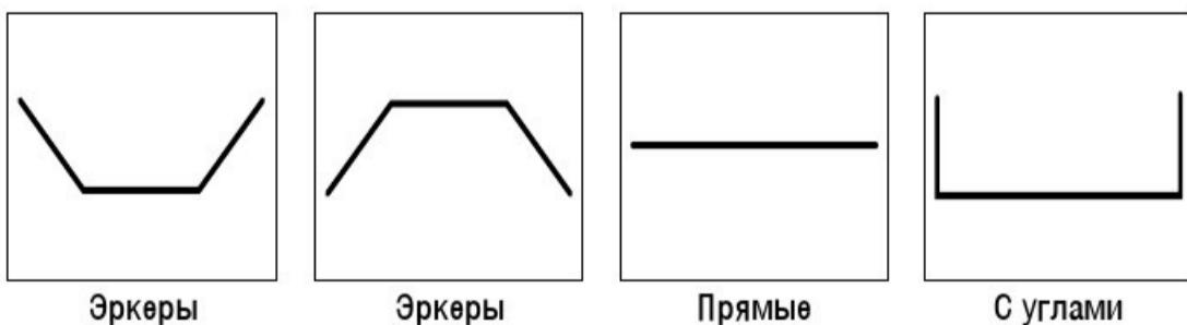
Если боковые стороны эркера больше 1,5 м, то изделие изготавливается в разобранном виде. Для сборки эркера возможны услуги монтажников фирмы.
